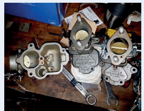
90 og 75 år gamle forgassarardelar ser nye ut etter ein omgang med vassblåsing.
